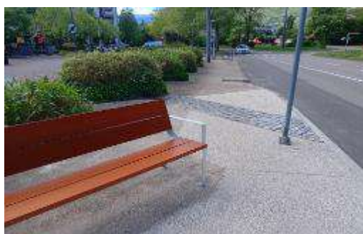
C – Avenue du Granier – Banc limitant la largeur du passage pour les PMR /poussettes
